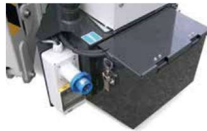
Panneau de commutation magnéto-thermique et entrée de ligne électrique 220 V.
