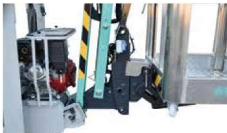
Compacité de l'ensemble flèche recevant le capteur de pesage et le système de montage rapide de la nacelle
