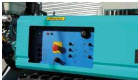
Panneau de commande bas facile d'accès et protégé à l'intérieur du cadre de protection
